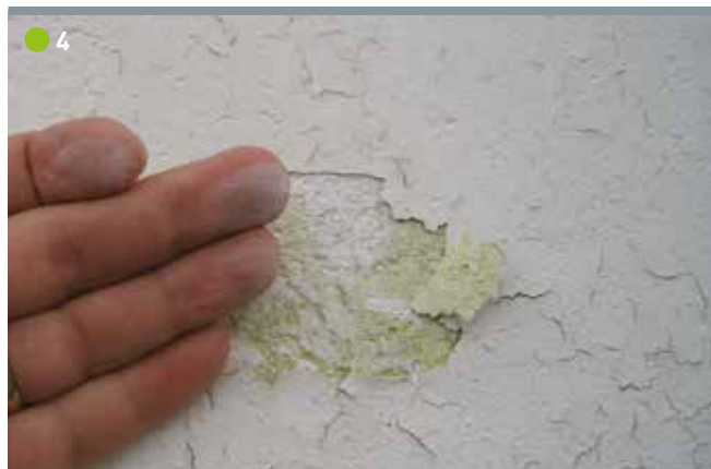
Preizkus prašnosti in »cvetenja« površine
